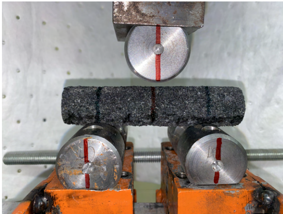
(a) Positionnement de la barre de PRFB sur les lignes tracées sur les appuis
