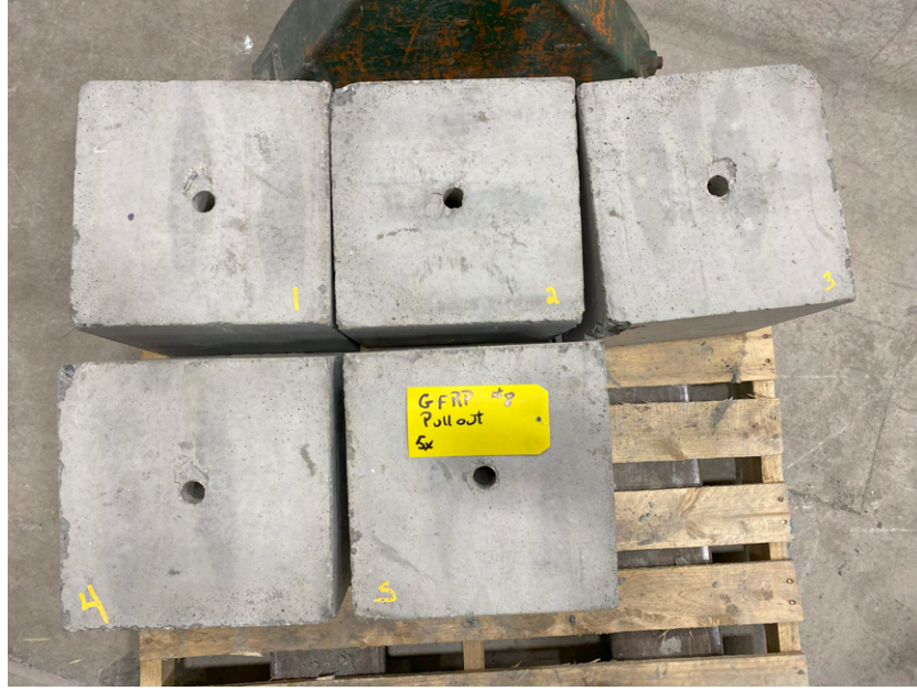
FIGURE 4.7 Blocs de béton après l'arrachement des barres
