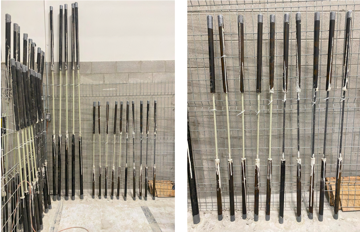
FIGURE 4.1 Préparation des barres de fibre de verre et de basalte pour les tests de traction
