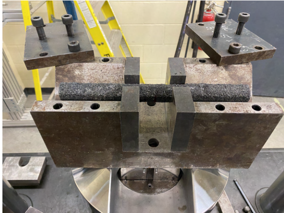
(a) Mise en place de la barre sur les deux lames inférieures
