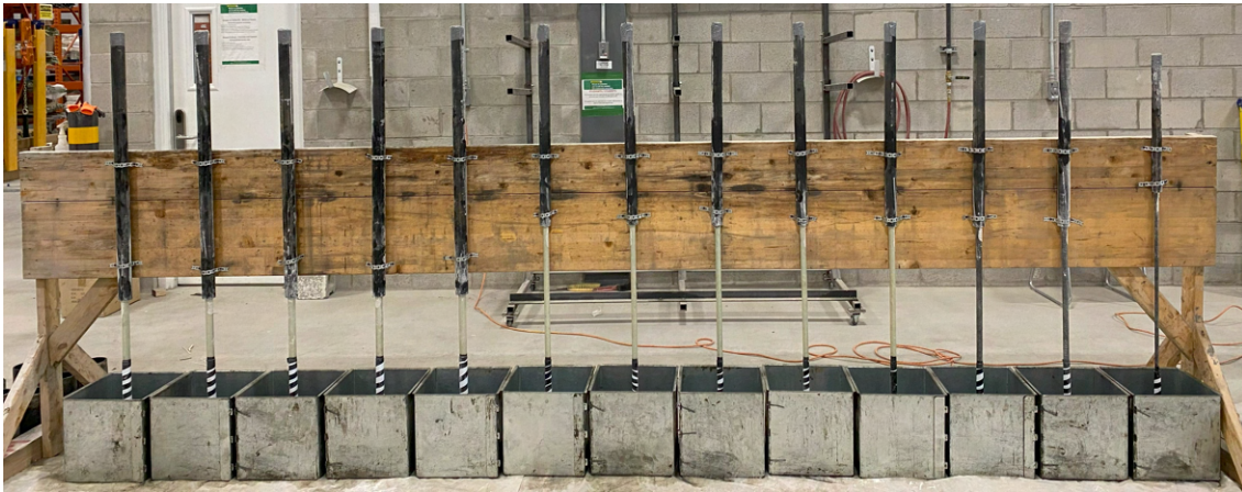
FIGURE 4.3 Préparation des spécimens en fibre de basalte et de verre pour les tests d'arrachements
