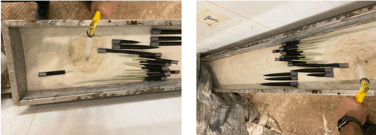
FIGURE 4.12 Préparation des spécimens pour les tests de traction sans charges
