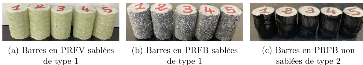
FIGURE 4.15 Teneur en fibres des barres sablées et non sablées
