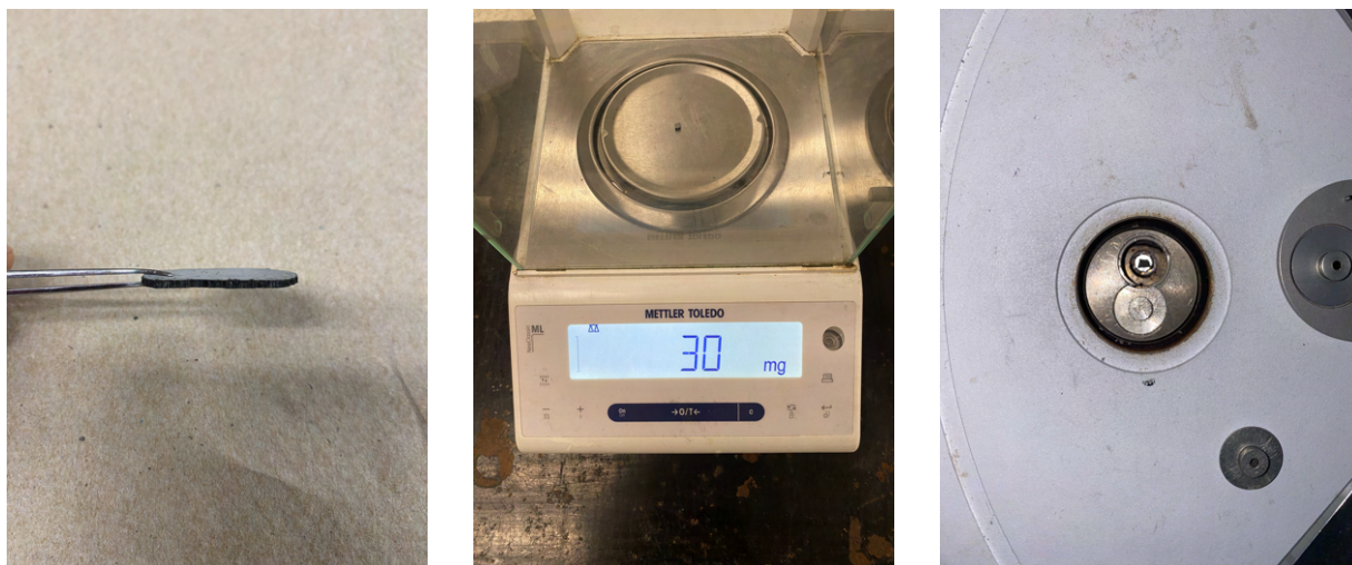
FIGURE 4.18 Préparation du spécimen pour le test de détermination de la température de transition vitreuse
