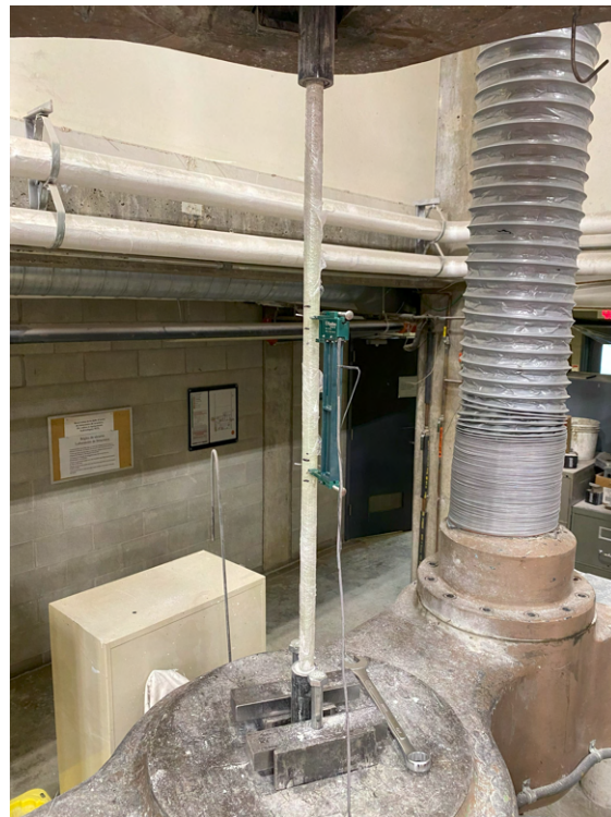
FIGURE 4.2 Mise en place de l'extensomètre de 200 mm
