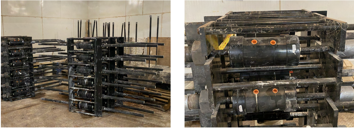
FIGURE 4.13 Préparation des spécimens pour les tests de traction avec charges
