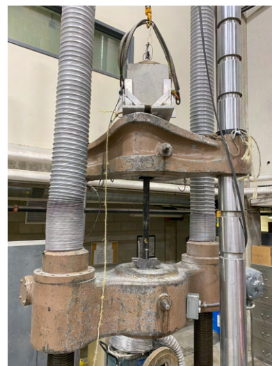
(c) Mise en place de l'ensemble de l'échantillon dans la machine MTS
