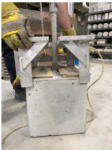
(a) Installation d'un dispositif pour maintenir le bloc de béton à sa place
